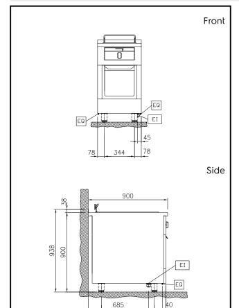
Electrical inlet (power) EQ **Equipotential screw**
